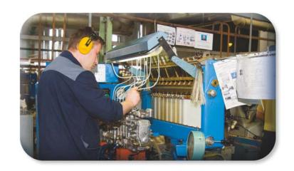
ТНВД с рядным вертикальным расположением плунжерных пар, количество секций - 6, межсекционное расстояние - 40 мм. Устанавливаются на двигатели с объемом цилиндра до 1,85 литра и цилиндровой мощностью до 37 кВт; обеспечивают цикловую подачу топлива до 167 мм<sup>3</sup>.
